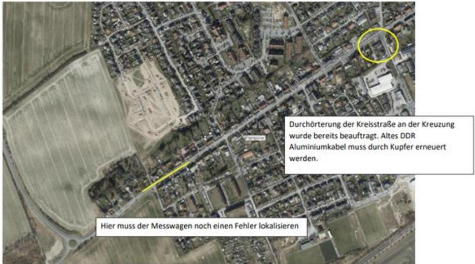
Für Mitte Mai ist ein Termin für die Durchörterung anvisiert. Dabei handelt es sich um ein gesondertes Verfahren zur Bodenverdrängung, um unterirdische elektrische Leitungen verlegen zu können. Die Planung für die Durchörterung hat etwas Zeit in Anspruch genommen. Außerdem ist ein Antrag auf verkehrsrechtliche Anordnung bei der unteren Verkehrsbehörde zu stellen und eine Firma mit der Verkehrssicherung im Kreuzungsbereich der Bahnhofstraße zu beauftragen.
